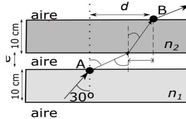
Nótese que los ángulos señalados entre los dos cristales en la figura anterior son todos iguales y serán denotados como  $\theta$ , mientras que el ángulo en la cara interna del segundo cristal es  $\theta'$ . Por otra parte, la distancia horizontal recorrida por el rayo de luz en el segundo cristal es  $d'$ .
