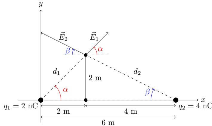
Para determinar el campo eléctrico generado en el punto (2, 2) m por las dos cargas, primero calculamos el campo generado por cada una de las cargas individualmente y luego sumamos ambos de manera vectorial. Observando el esquema del problema proporcionado en el dibujo anterior obtenemos las siguientes relaciones:
