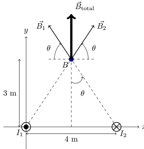
El seno del ángulo  $\theta$  para el punto  $B$  se calcula utilizando la distancia entre  $B$  y cualquiera de los hilos:
